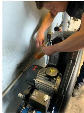
↪ Contrôle du groupe électrogène : niveau d'huile, gazole, batterie
