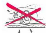
La circulation de véhicules et le stationnement sont interdits sur les ouvrages, ainsi que les zones de stockages.
