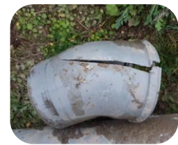
Remplacement d'un coude sur le réseau à Auxelles-Haut
